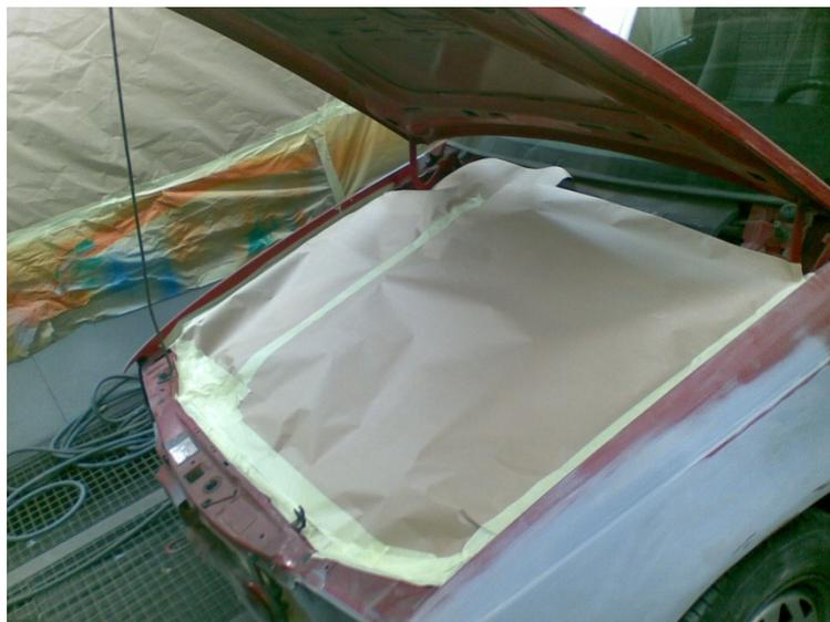
**En la primera foto vemos el capó levantado con el motor descubierto para ser enmascarado, en la segunda foto se está enmascarando junto con el hueco de los parabrisas y por último el motor ya está enmascarado para no ser pulverizado a la hora de pintar el capó.**
