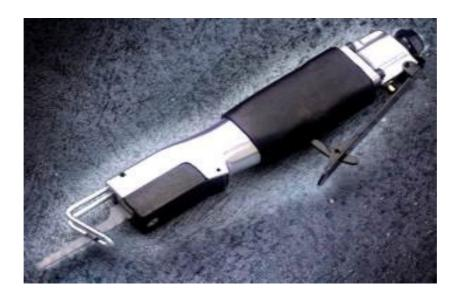
La sierra neumática o también llamada caladora neumática manual, es una de las herramientas de corte más utilizadas actualmente por los chapistas en las reparaciones de carrocerías. Al ser neumática, obviamente funciona por aire y a una presión de entrada comprendida entre 6 y 8 bares en casi todos los modelos manuales, con un consumo aproximado de 120 l/m trabajando a 10.000 revoluciones por minuto.
