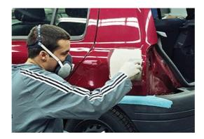
Hoy en día, las masillas que se emplean en pintura se denominan "masillas de poliéster", ya que el aglomerante que contiene son resinas de poliéster insaturado, que endurecen mediante una reacción química de polimerización al añadirles un catalizador o iniciador de la reacción en una proporción de mezcla que generalmente es de 2 ó 3% en peso.
