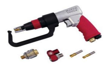
La despunteadora neumática es un taladro "especial" de aire comprimido que se usa para el despunteado de las soldaduras por puntos de resistencia. Es especial porque incorpora un sistema el cual nos permite ajustar la profundidad y la velocidad de corte con mucha exactitud.
