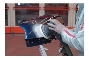
Las masillas empleadas en el repintado de vehículos no proporcionan al acero ninguna protección frente a la corrosión ni son una buena base sobre la cual aplicar las pinturas de acabado (pueden provocar rechupados), sino que su única función es la de nivelación superficial, debiendo utilizar la masilla adecuada en cada caso, con la máxima calidad, y en unos espesores moderados.
