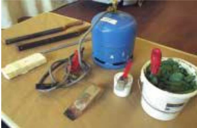
materiales a soldar es baja y se pueden soldar materiales diferentes, sin embargo la resistencia mecánica y térmica de la soldadura es baja. La soldadura blanda más común en la reparación de automóviles es la del Estaño + plomo. A esta soldadura se le conoce como proceso de estañado
