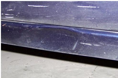
Una vez tengamos el bollo sacado a la posición natural de la pieza, y retirados los elementos que hayamos necesitado soldar en el proceso, podemos desbarbar con un disco de lija de radial para eliminar todas las rebabas de la soldadura y se puede dar por terminado la reparación por una sola cara
