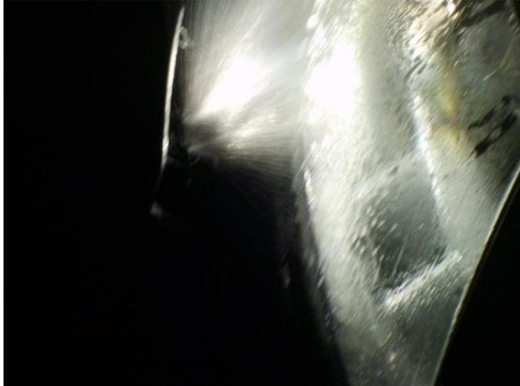
En esta imagen se aprecia a en la parte inferior la tapa de los eyectores del lavafaros.
