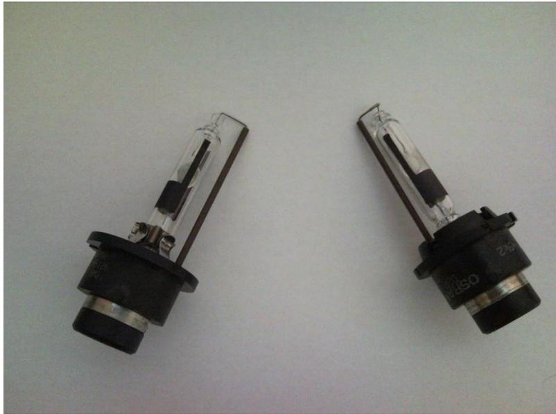
Para el funcionamiento se requiere un dispositivo electrónico que debe llevarlo el vehículo que utilice estas lámparas, el dispositivo enciende la lámpara y controla el arco. Para el encendido el sistema electrónico eleva la tensión entre los electrodos por medio de un arco voltaico de hasta 30.000 voltios del interior de la ampolla creándose un arco de luz gracias al gas xenón y a la gasificación de los halogenuros metálicos.
