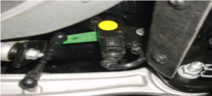
Tras el análisis de estos sensores la señal excita a los servomotores del faro, compensando así el desnivel del vehículo.
