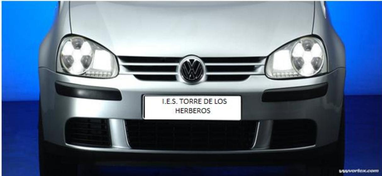
Los chips individuales se controlan a través de una modulación de duración de impulsos. Esto permite, por un lado, la conexión y desconexión de los chips LED individuales y, con ello, la generación de diferentes geometrías claro-oscuro; y, por otro lado, la modulación de la intensidad en la distribución de la luz.
