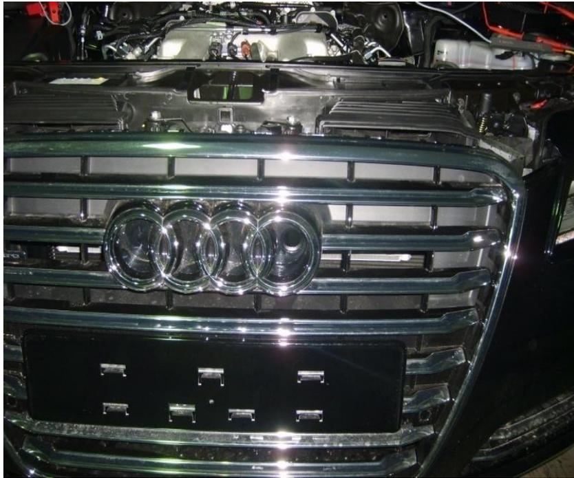
En esta imagen se aprecia la cámara de visión nocturna en el aro de la derecha de la calandria.
