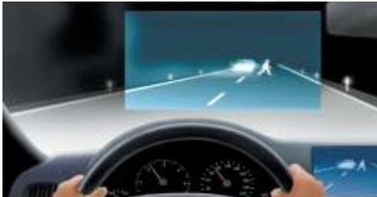
Un faro de infrarrojos ilumina la zona lejana (a una distancia de hasta 150 metros del vehículo) que resulta invisible al ojo humano. La luz infrarroja reflejada por posibles objetos situados muy por delante del vehículo y esta luz, es captada por la cámara como imagen en escala de grises y se visualiza en una pantalla cerca del volante.
