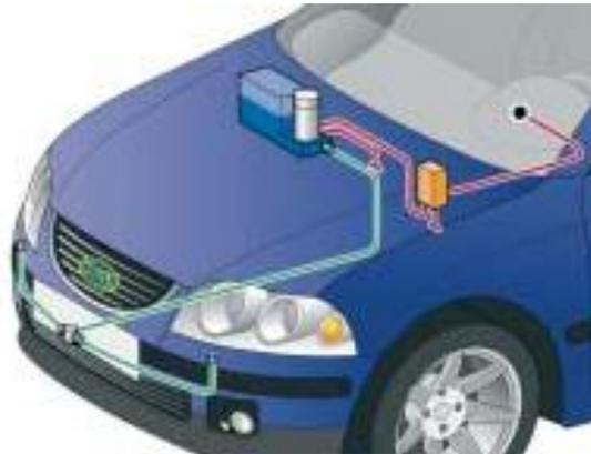
**4-MODULO DE ENCENDIDO O REACTANCIA:** inflama la mezcla de gases del interior de la lámpara. Para ello provoca impulso de alta tensión de hasta 30 Kv , que provoca el salto de una chispa entre los electrodos de la lámpara. Controla el encendido de la lámpara para que ésta alcance rápidamente su fase operativa, y a continuación regula la potencia de la lámpara.
