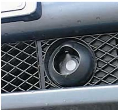
Con una cámara de visión nocturna y la luz infrarroja mezclada con la de los faros, la cámara tiene un alcance de 200 metros, siendo captados los vehículos, personas o animales, gracias al calor que emiten el motor o sus cuerpos. Un procesador filtra la información y evalúa si se acercan o se alejan de nuestra trayectoria. En caso de acercamiento el objeto es iluminado, hasta que entre en la zona de iluminación de los faros.
