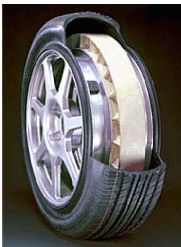
*Neumático Run Flat seccionado*
