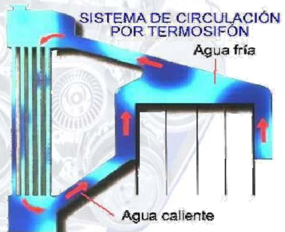
**Figura 5.2.** Sistema de refrigeración por termosifón.
