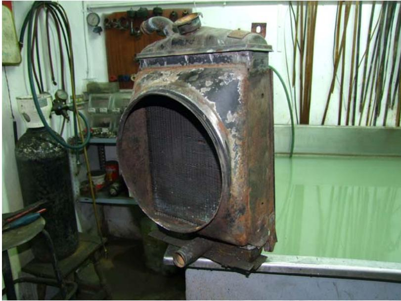
**Figura 5.5.** Radiador de refrigeración (SEAT 600).
