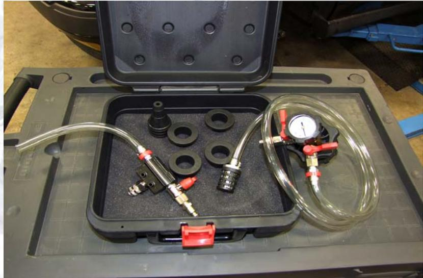
**Figura 6.6** Útil purgador de circuitos de refrigeración.
