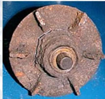
**Figura 6.4.** Bomba de agua en mal estado.
