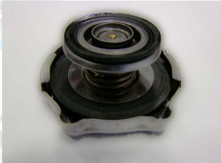
**Figura 5.15.** Tapón presostato.
