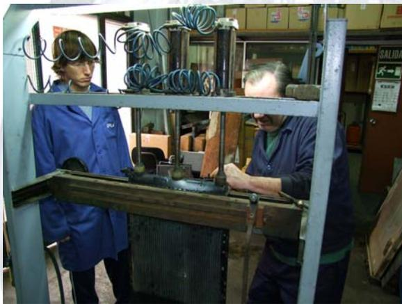
Figura 6.6. Proceso de limpieza de un radiador.
