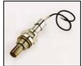
Situada en el tubo de escape del auto se busca en su colocación la mejor posición para su funcionamiento cualquiera sea el régimen del motor. La temperatura óptima de funcionamiento de la sonda es alrededor de los 300° o más.
