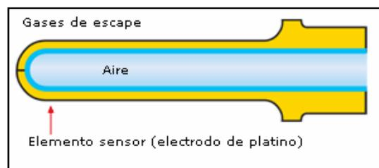
El elemento de dióxido de circonio pasa a ser conductor de los iones de oxígeno a una temperatura de aproximadamente 300°C.
