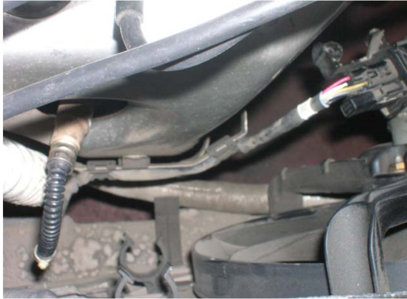
Sonda lambda de banda ancha.
