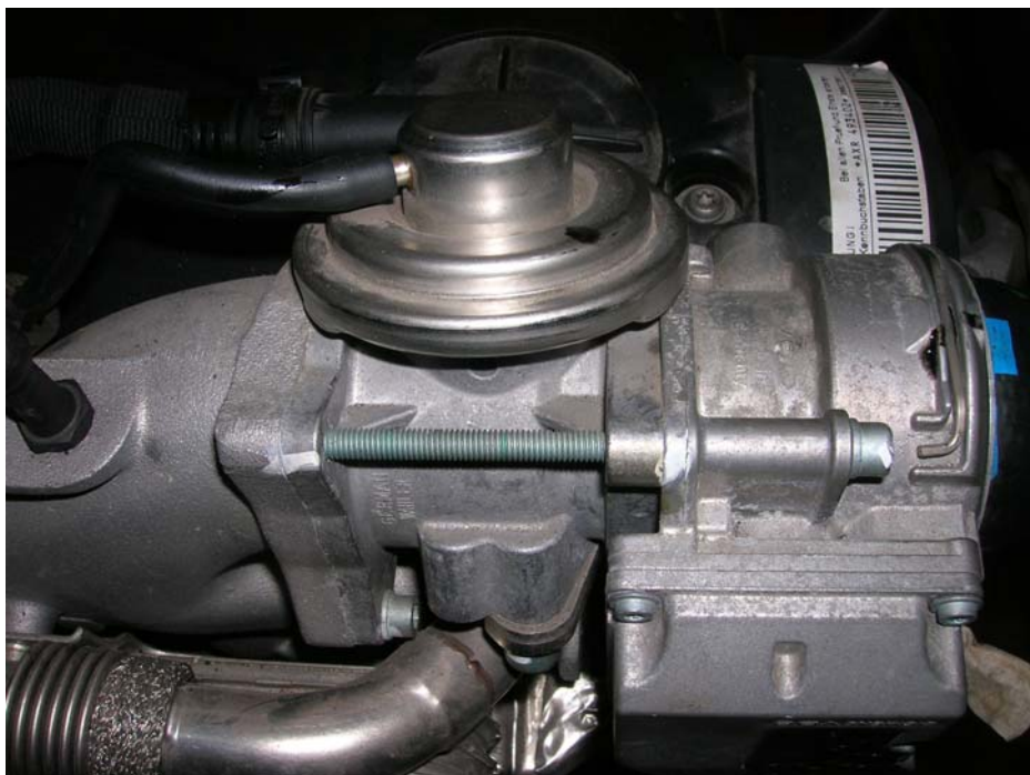
Válvula AGR accionada por vacío.
