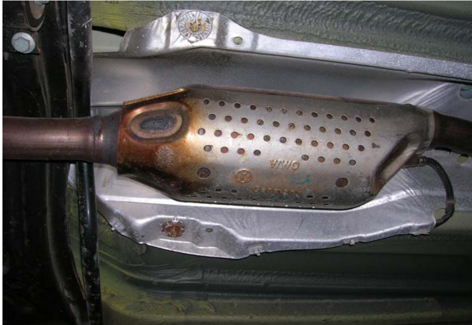
Catalizador con sonda lambda de dos puntos.
