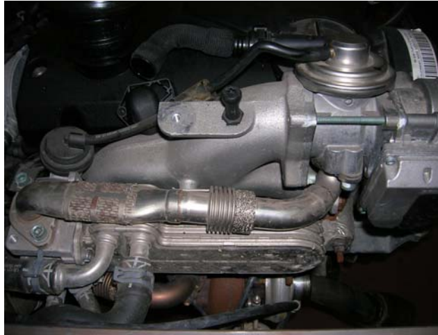
Sistema de refrigeración de la AGR.
