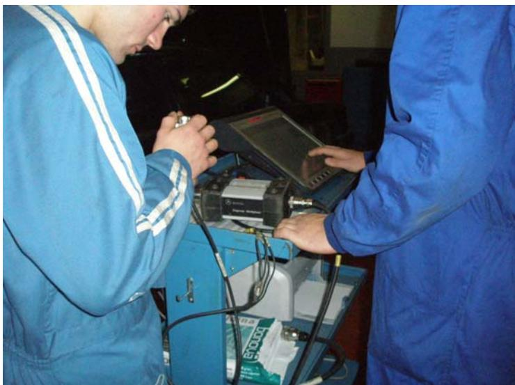
La máquina utilizada para las comprobaciones fue la DAIMLER CHRYSLER STAR DIAGNOSIS COMPACT 3, con el programa XENTRI – DAS.
