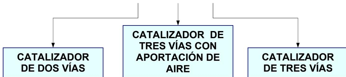
Catalizador de dos vías: También llamado catalizador de oxidación, convierte los hidrocarburos y el monóxido de carbono contenidos en los gases de escape por oxidación, es decir, combustión, en vapor de agua y dióxido de carbono. El oxígeno necesario para la oxidación se obtiene de un ajuste pobre de la mezcla ( $\lambda > 1$ ) o mediante la insuflación de aire en el sistema de escape delante del catalizador. Los óxidos de nitrógeno no pueden ser transformados por el catalizador de oxidación
