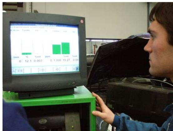
Analizador de gases BOSCH 3.250 parte en el concesionario BI – ONDO sobre un Mercedes E 500 con el analizador BOSCH 3.250, las mediciones fueron las siguientes:
