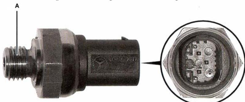
Transmisor de contrapresión de los gases de escape. A.- Toma de medición de presión.
