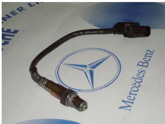
En relación con el sistema de filtración de partículas PM, la unidad de control CDI emplea la señal de la sonda lambda para poder calcular con exactitud la cantidad y el momento de la post-inyección para el ciclo de regeneración. Para contar con una regeneración eficaz del filtro de partículas se necesita un contenido mínimo de oxígeno en los gases de escape y una alta temperatura uniforme de los gases. Esta regulación resulta
