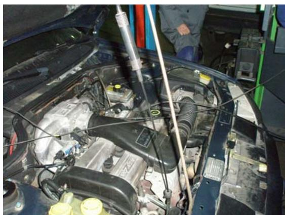
El sistema de regulación de los gases de escape se efectúa en este vehículo con un catalizador de 3 vías con sonda lambda calefactada.. El analizador utilizado es el BOSCH 3.250 del Instituto.
