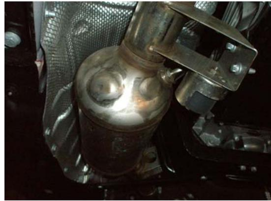
Filtro de partículas (DPF) con las tuberías anterior y posterior hacia el transmisor de presión Mercedes Benz ML280 CDI
