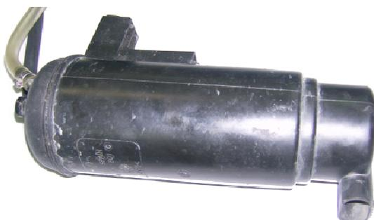
El canister está unido herméticamente al depósito de combustible mediante una
