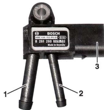
es ML280 CDI. 1.- Empalme de presión de gases de presión trasero. 3.- Conexión eléctrica
