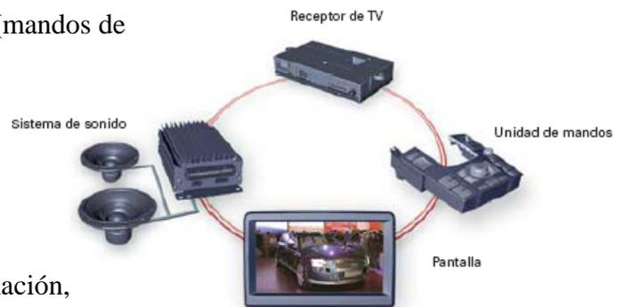
con sus correspondientes protocolos de comunicación, arbitrajes, etc. Pero en vez de utilizar un soporte de bus de cables de cobre se usa un conductor opto electrónico (LWL) que se encarga de que las ondas luminosas generadas en un transmisor de una unidad de control sean conducidas hacia el receptor de la otra unidad de control.
