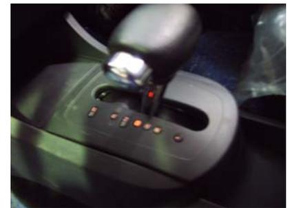
El vehículo, por seguridad se deberá poner en marcha en esta posición. Para seleccionar otra posición en la palanca, habrá que pisar el pedal de FRENO y accionar a la vez el
