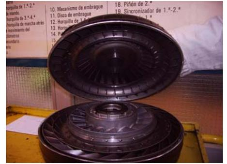
La segunda de las turbinas tiene los alabes diseñados de tal manera que el movimiento del aceite, producido por la primera turbina, "choca" contra estos y la impulsa, iniciando así un movimiento giratorio.
