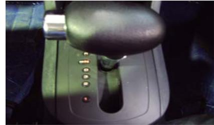
✚ D. Es la posición normal de conducción en el Cambio Automático. Esta posición le permite al módulo eléctrico seleccionar cualquiera de las relaciones de transmisión que tiene “cartografiadas”, desde la más corta a la más larga, de forma autónoma y sin la necesidad de que el conductor accione ningún otro mecanismo.
