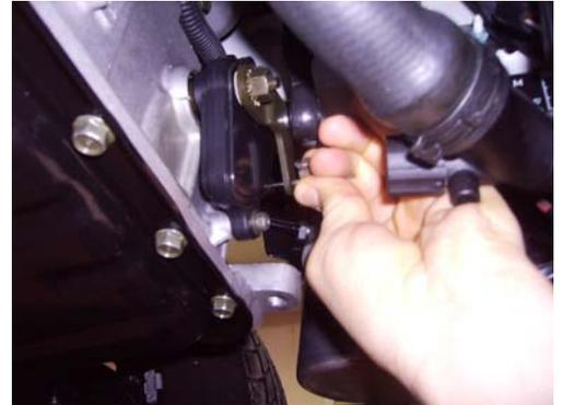
relativa de la palanca. La palanca tiene una posición determinada, normalmente la posición P, con un enclavamiento en la mariposa de selección, sita en la caja, para la regulación de la misma, evitando problemas de selección de marcha.
