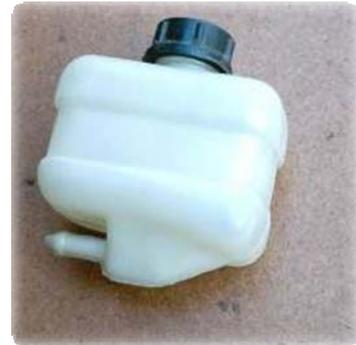
En su interior dispone de un medidor de nivel, para indicar en el cuadro de mandos que hay una avería en el circuito si el nivel es demasiado bajo. Consiste en un flotador unido al tapón, con dos contactos, de tal forma que si baja excesivamente el nivel, los contactos se puentearan y se encenderá la luz del cuadro.
