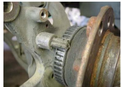
Los sensores activos están formados por una corona magnética formada por 50 pares de polos (2) que sustituye la corona dentada de los sensores inductivos y suele ir solidaria del mismo rodamiento. Siendo los sensores activos (1) muy similares a los sensores inductivos.
