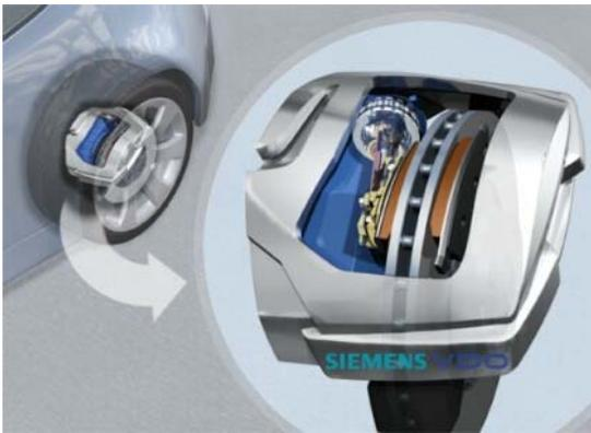
Debido a su mayor rendimiento, sus dimensiones también serán menores, lo que reducirá el peso total del vehículo, y podrá prescindir de las tuberías de freno, del servomotor y del depósito de líquido de frenos. Esto liberará un volumen de cerca de 22 litros en el compartimiento del motor y dará mayor libertad a los diseñadores del vehículo.
