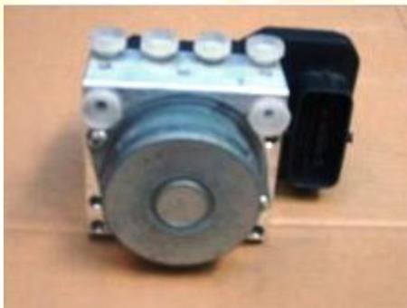
El grupo de regulación hidráulico se compone de varias electroválvulas, un émbolo y una bomba de reinyección.
