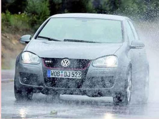
La regulación antipatinado o también llamado control de tracción, es utilizada en complemento del sistema antibloqueo de frenos, permite mejorar la seguridad de conducir y facilitar la tarea del conductor en situaciones de conducción en las que se alcanza el límite de estabilidad del vehículo. (Carreteras nevadas, heladas, o charcos de agua).
