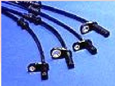
Existen varios tipos de sensores de ruedas, pero los más utilizados son los de tipo inductivo, y van montados en posición perpendicular al eje de la rueda dentada que está montada sobre el palier de transmisión. La función de estos sensores, es la de informar a la unidad electrónica de la velocidad del vehículo, así como también, de que las ruedas están girando.
