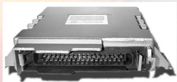
Durante la frenada, si alguna de las ruedas intenta bloquearse, la unidad electrónica manda, simultáneamente, las electroválvulas y la bomba de reinyección para modular la presión de la frenada.
