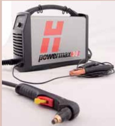
resulta apropiado para numerosas aplicaciones en talleres de reparación. El equipo de corte por plasma transforma la corriente generada por la máquina en un chorro de plasma de alta densidad y energía. Éste se origina al paso del aire a presión a través del arco eléctrico que se produce entre el electrodo y la pieza.
