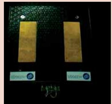
En automoción, genera energía a partir de las deformaciones de neumáticos, suspensiones, etc., disminuyendo el gasto de combustible. Los "guardias tumbados" aprovechan el paso de los vehículos, por ejemplo, para iluminar las señales de tráfico. Los montan, entre otros, la empresa Abaccus Soluciones e Innovación.
