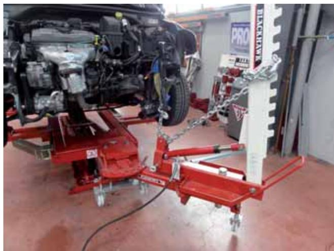
En el minibanco pueden efectuarse estirajes de componente simple, que estén dentro del radio de acción de la torre y no precisen de una gran potencia de tiro (se puedan resolver teniendo como única fuerza de reacción las propias mordazas de amarre del vehículo). Dada la configuración de la plataforma del minibanco, para colocar un contratiro se necesitaría una segunda torre, lo que iría en contra de la funcionalidad de este equipo.
