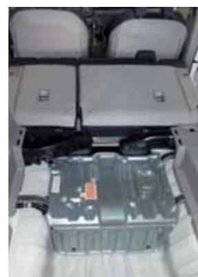
► Desconector de la batería de tracción
