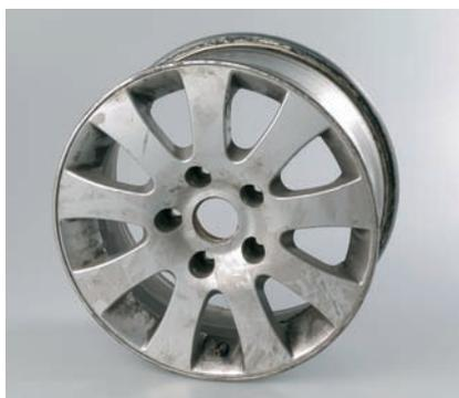
**2) Limpieza:** este proceso es muy importante para conseguir un buen resultado, ya que las llantas, sobre todo las delanteras, acumulan bastante suciedad y grasa, que si no es eliminada dará problemas de adherencia de la pintura y siliconas en el acabado. Para este paso existen productos específicos para llantas que facilitan su limpieza, además de emplear esponjas y agua a presión. En los talleres especializados se suele realizar la limpieza sumergiendo la llanta en
