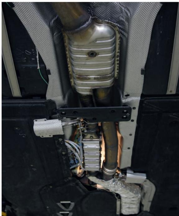
*Sistema generador de corriente eléctrica TEG de BMW integrado en la línea de escape.*
