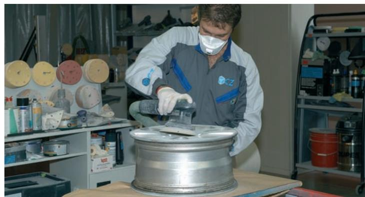
**4.2) Aplicación de una capa fina de imprimación epoxi sobre la zona que se va a enmasillar.** Esta imprimación tiene la función de promover la adherencia de la masilla sobre el aluminio de la llanta, obteniendo mejores resultados.
