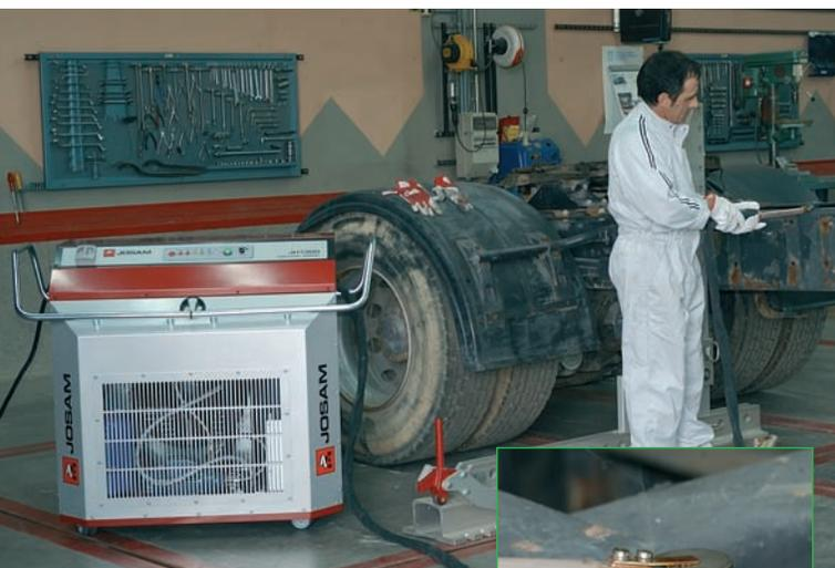
*Calentamiento del ala de la viga de un bastidor de camión con el equipo de inducción.*
