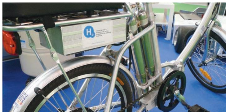
El hidrógeno contenido en los depósitos de hidruro, es suministrado a una pila de combustible ubicada sobre la rueda trasera, donde se genera la corriente eléctrica necesaria para alimentar un motor eléctrico de asistencia al pedaleo.
