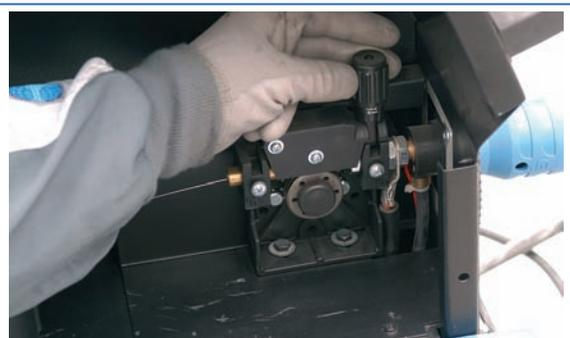
**4** Ajuste de presión de roldanas de tracción.
