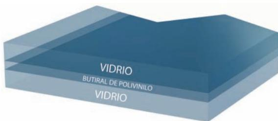
*Estructura de un vidrio laminado.*
