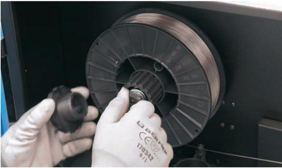
**5** Ajuste del freno para evitar inercia en la bobina.
