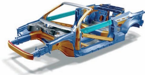
Actualmente, la aparición de los aceros de muy alta resistencia (límite elástico entre  $450$  y  $800\text{ N/mm}^2$ ) y **ultra-alta resistencia** (límite elástico superior a  $800\text{ N/mm}^2$ ) y su utilización en las carrocerías ha permitido aligerar las estructuras reduciendo el peso del conjunto, además de aumentar el nivel de seguridad.
