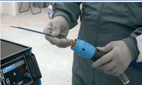
**7** Verificar estado de la manguera y limpieza del tubo guía de alambre.
