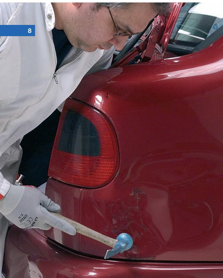
*Cuando se tiene fácil acceso por ambos lados de la deformación, la técnica de reparación más rápida es el martillo y tas.*
