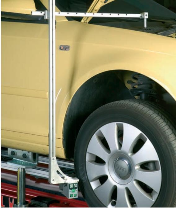
Útil para la medición del McPherson.
