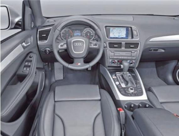
miento. El conductor puede dejar que el S-Tronic gestione los cambios de modo completamente automático o hacerlo él mismo de forma manual opcionalmente, mediante levas de cambio en el volante.
