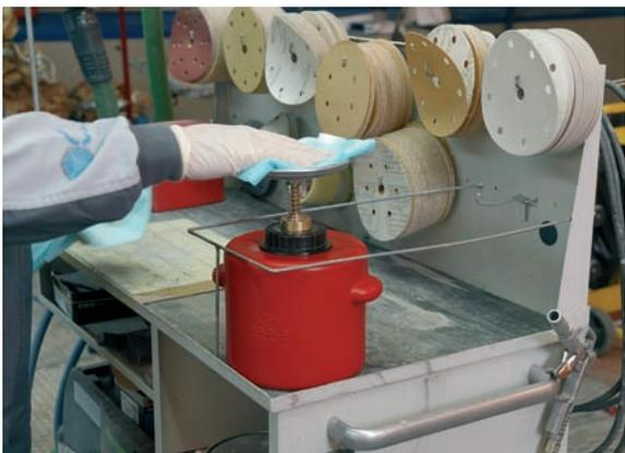
jas que aporta son un menor esfuerzo para el trabajador al no tener que levantar peso, menor evaporación de disolventes a la atmósfera y un menor consumo de disolvente, ya que el exceso vuelve al recipiente y no se derrama nada al suelo.
