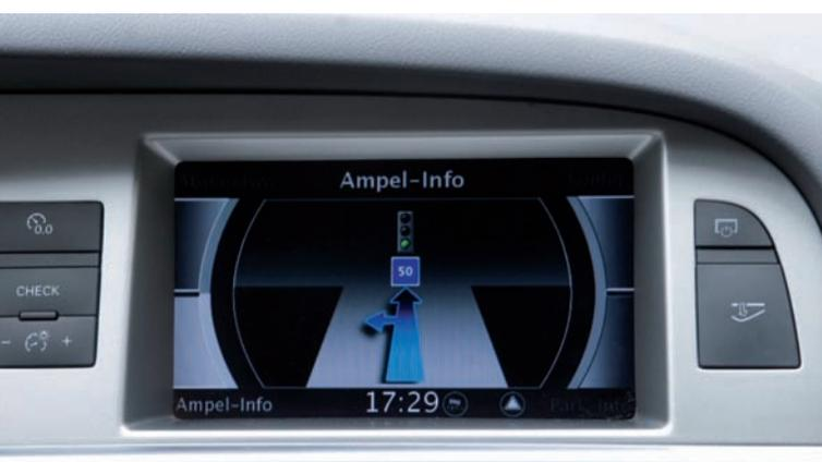
El sistema se aplicó a 46 semáforos del área metropolitana de Ingolstadt (Alemania). El software instalado en estos dispositivos optimiza el funcionamiento de la red de semáforos, reduciendo significativamente la duración de las paradas de los vehículos. Los semáforos, comunican a la unidad de mando del coche el tiempo restante hasta que éstos estén en verde y así se les permita circular.
