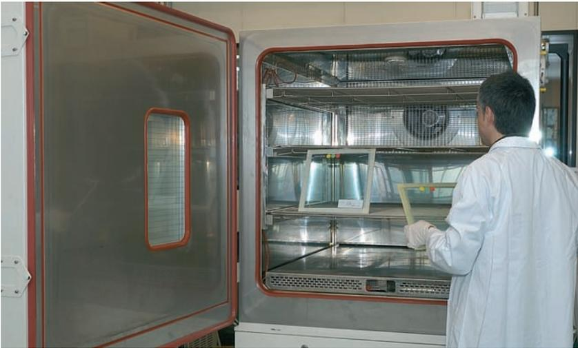
*Ensayo de resistencia a temperaturas elevadas*
