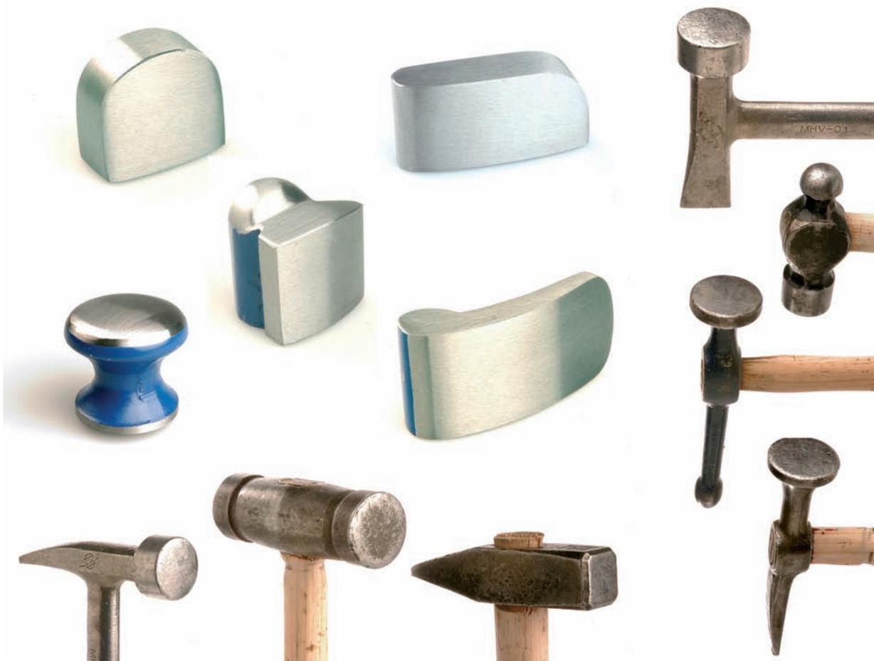
**P**ara el trabajo de desabollado de las superficies existen diferentes herramientas y útiles que facilitan al técnico este trabajo. Estas herramientas se adaptan a los diferentes daños que se pueden presentar en la chapa: de mayor o menor magnitud, sin daños en pintura, con o sin accesibilidad para trabajar, etc. En cualquier caso, disponer de las herramientas adecuadas a cada tipo de daño facilita y reduce los tiempos de reparación.
