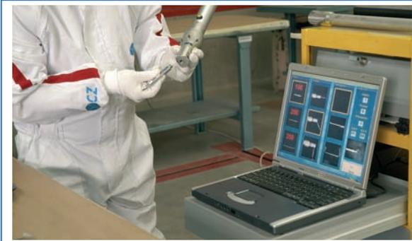
**5** Colocar el puntero seleccionado en el brazo de medición.
