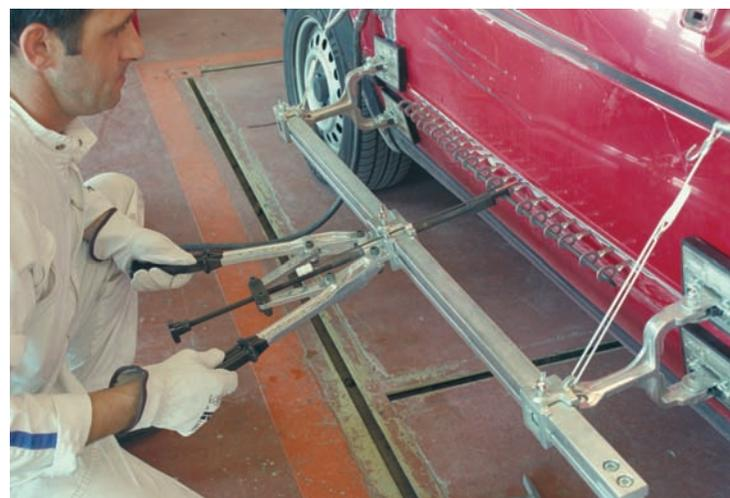
Los dispositivos de tracción exterior mediante la soldadura por resistencia eléctrica disponen de diferentes puntas para adaptarse al tipo de daño.
