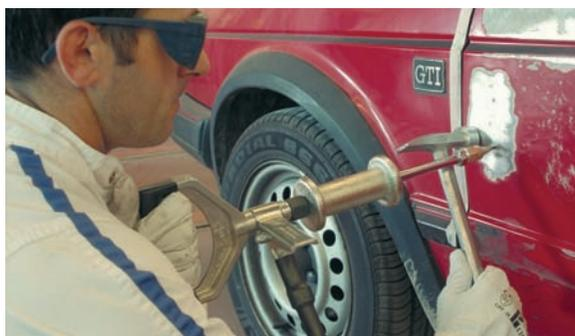
*Dispositivos con doble función: soldar y traccionar.*
