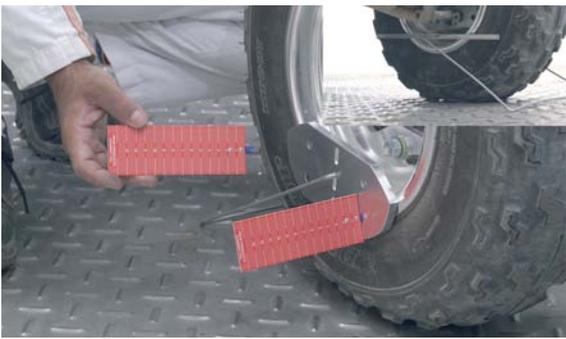
**5** Colocación de los soportes y de las tarjetas en las ruedas delanteras.
