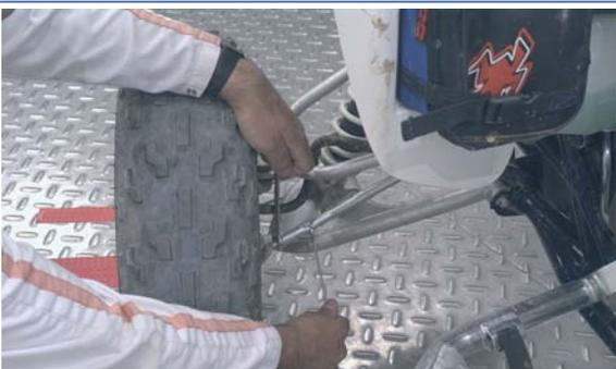
**7** Ajuste de la alineación, regulando las bieletas de la dirección.
