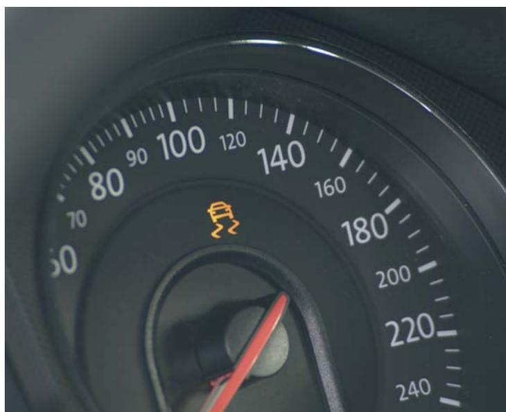
*Si el ESC esta desconectado o si hay algún fallo en el mismo, el testigo luminoso permanece encendido constantemente.*
