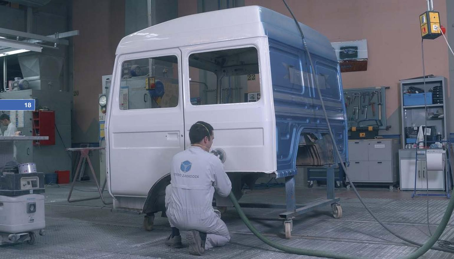
**Selladores:** Monocomponentes o bicomponentes, empleados sobretodo en la personalización de flotas, por cambios de color sin ser preciso el previo lijado de toda la superficie, o para aislar pinturas antiguas.
