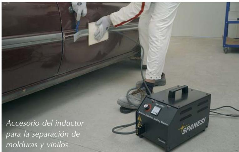
*Accesorio del inductor para la separación de molduras y vinilos.*
