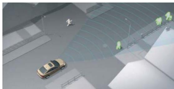
Estos sistemas alertan al conductor en el caso de que la trayectoria de un peatón vaya a interferir en la del vehículo.
