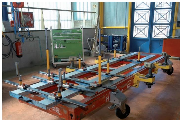
*Bancada universal con sistema de medición mecánico: medidor independiente.*
