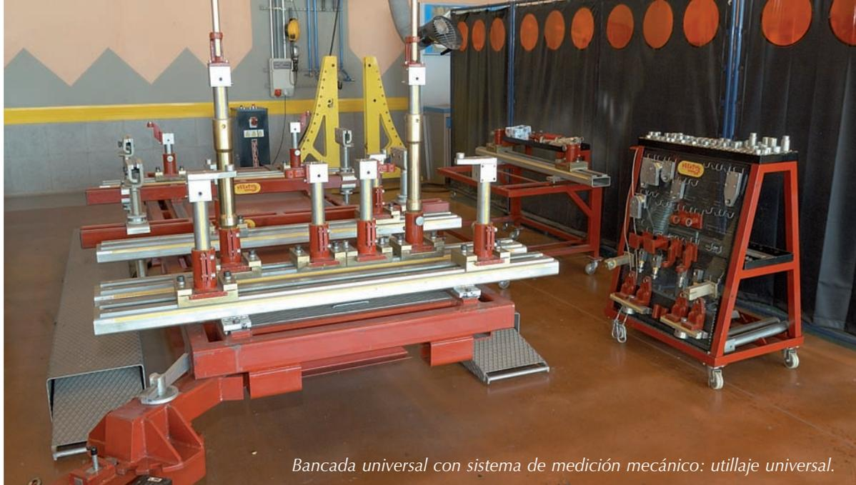
*Bancada universal con sistema de medición mecánico: utillaje universal.*
