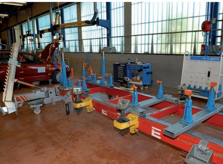
*Montaje de una bancada de utillajes.*
