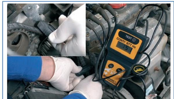
**8** Medición de la tensión de la correa de transmisión. El sensor se coloca en la posición indicada en el paso 6 y sin estar en contacto con la correa.
