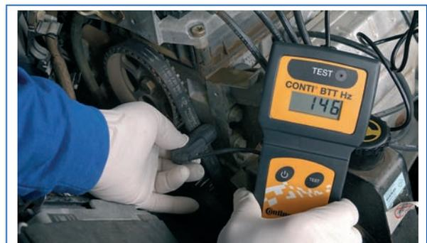
**10** Volver a medir la tensión de la correa de transmisión.
