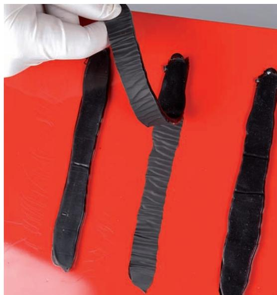
Ensayo de pelado sobre chapa pintada.
