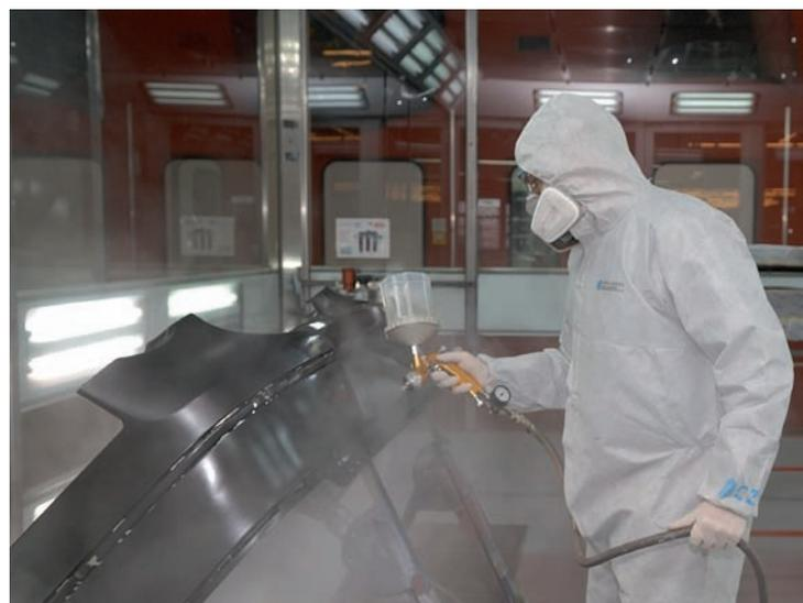
Un objetivo que se ha marcado DeVilbiss en el diseño de esta pistola es que su limpieza y mantenimiento fuese sencillo y rápido. Y lo ha conseguido. Con la llave mixta (para el pico de fluido y los conectores hexagonales) y el destornillador de punta plana (para la empaquetadura autoajustable de la aguja) y punta Torx (para el gatillo) que acompañan a la pistola, son suficientes para desmontar y montar totalmente la pistola.
