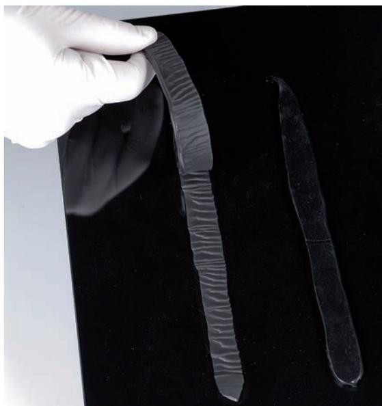
Ensayo de pelado sobre vidrio serigrafiado.
