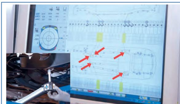
**6** Establecer el plano de referencia en la carrocería mediante cuatro puntos que no presenten daños.
