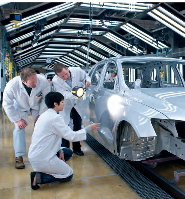
**E**l proceso de pintado en fábrica se realiza con la carrocería desnuda, después del corte, embutición y ensamblaje de la chapa, sin elementos plásticos, mecánicos o eléctricos. Las piezas de plástico se pintan en una línea a parte o incluso en otra fábrica, ya que éstas no precisan una protección anticorrosiva como la chapa y la pintura tiene que adaptarse a la mayor flexibilidad de las piezas.
