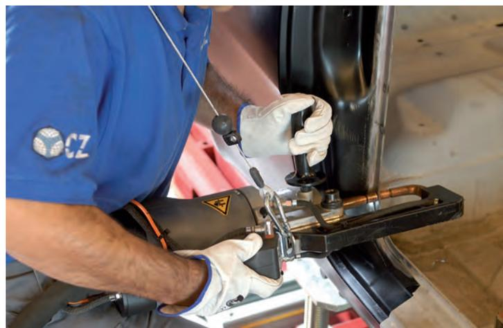
Con relación al reconformado, la técnica de batido de paneles con martillo y tas, con acceso por ambos lados se utiliza con menor frecuencia, dejando paso al reconformado por sistemas de tracción con acceso por un solo lado, de forma que son necesarios menos desmontajes para llevar a cabo la reparación.
