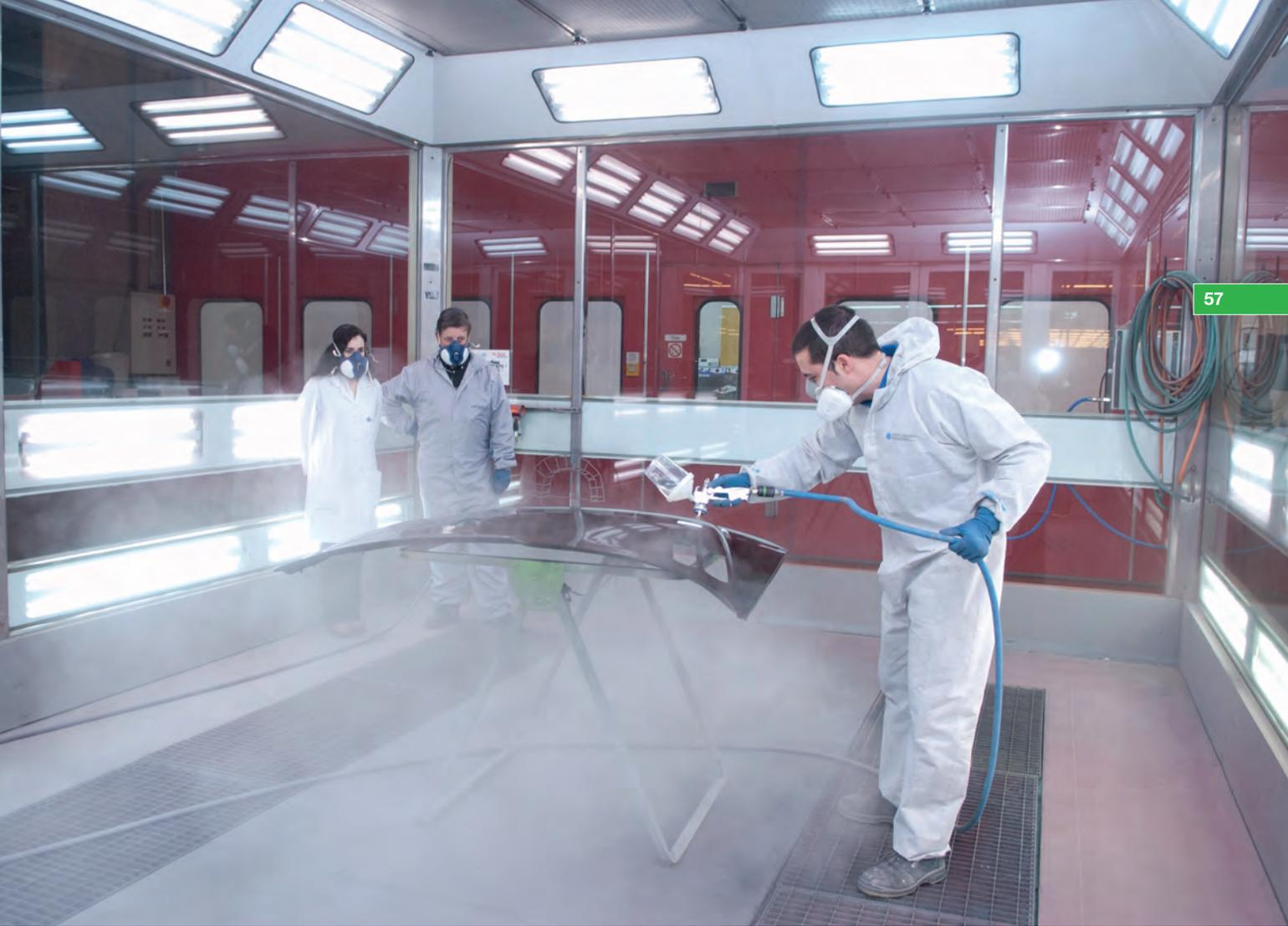
Su aplicación puede realizarse con una mano fina seguida a continuación de una mano normal, es decir, una sola aplicación, o con dos manos con un tiempo de evaporación entre ellas de 5 minutos, consiguiendo espesores de 40 a 70 micras.
