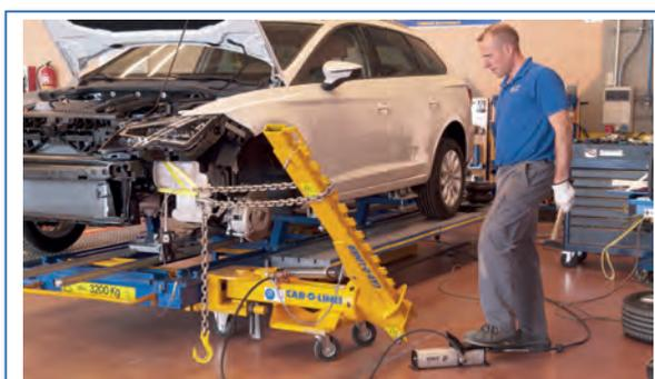
**9** Montar el equipo de estiraje y realizar el estiraje en las zonas deformadas.
