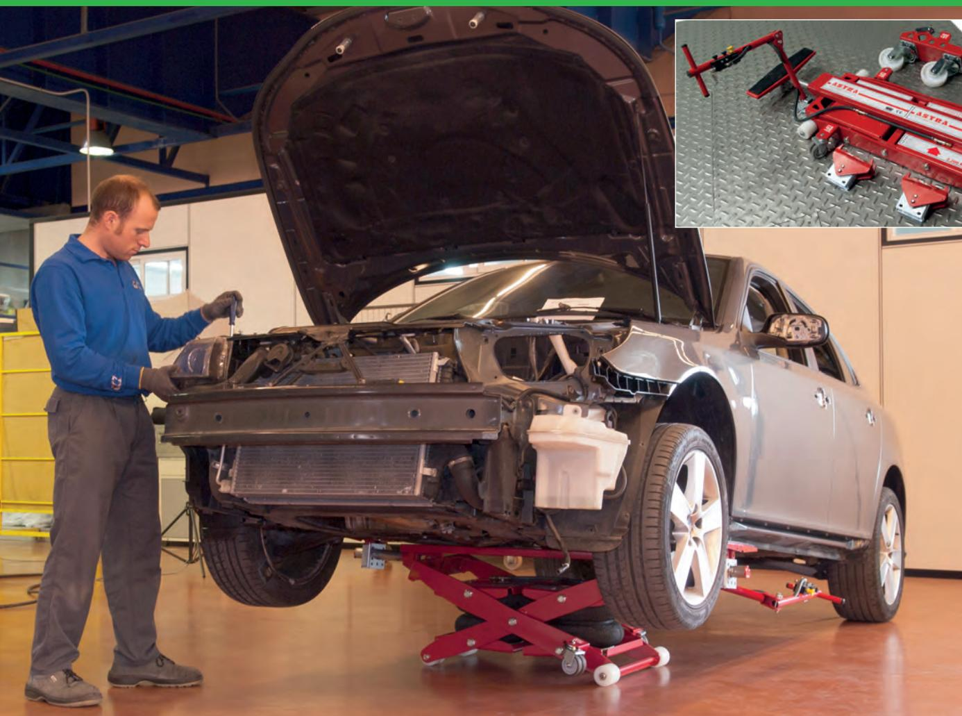
El miniLIFT Low de ASTRA es un elevador neumático de tijera portátil, de dimensiones reducidas, que permite levantar la parte delantera o trasera del vehículo para facilitar los trabajos de reparación.
